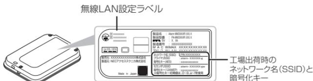
表面ラベルの「ネットワーク名 (SSID)」には、上段にプライマリ SSID、下段にセカンダリ SSID の無線設定内容 (SSID、暗号化モード、暗号化キー) が表示されています。
