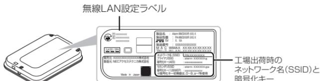
裏面ラベルの「ネットワーク名 (SSID)」には、上段にプライマリ SSID、下段にセカンダリ SSID の無線設定内容 (SSID、暗号化モード、暗号化キー) が表示されています。
